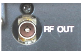
Ici une sortie antenne d'un magnétoscope.
