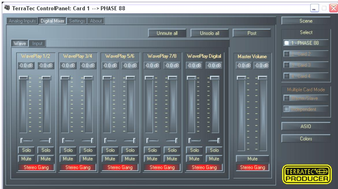
El Mezclador digital mezcla todas las señales reproducidas por los controladores y también combina las señales pendientes en las entradas físicas. Conmute entre las páginas 'Wave' e 'Input' para ver los niveles y controlar los volúmenes.
