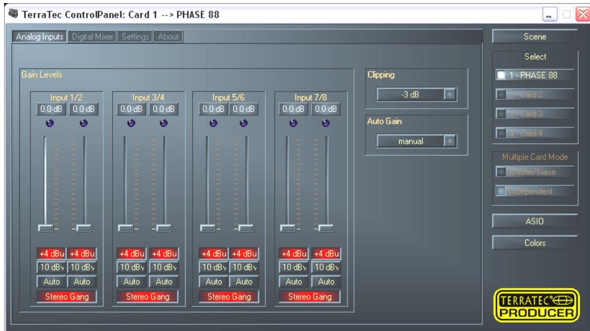
De la izquierda a la derecha, usted puede ajustar el nivel entrante con el cual la señal de audio se introduce en el sistema PHASE 88. -10 dBV es muy común en los home studios (a este nivel, las señales son relativamente suaves y la entrada compensa esto con una alta sensibilidad). +4 dBu se usa generalmente en entornos profesionales (los dispositivos poseen la suficiente potencia y la sensibilidad de entrada es menor).
