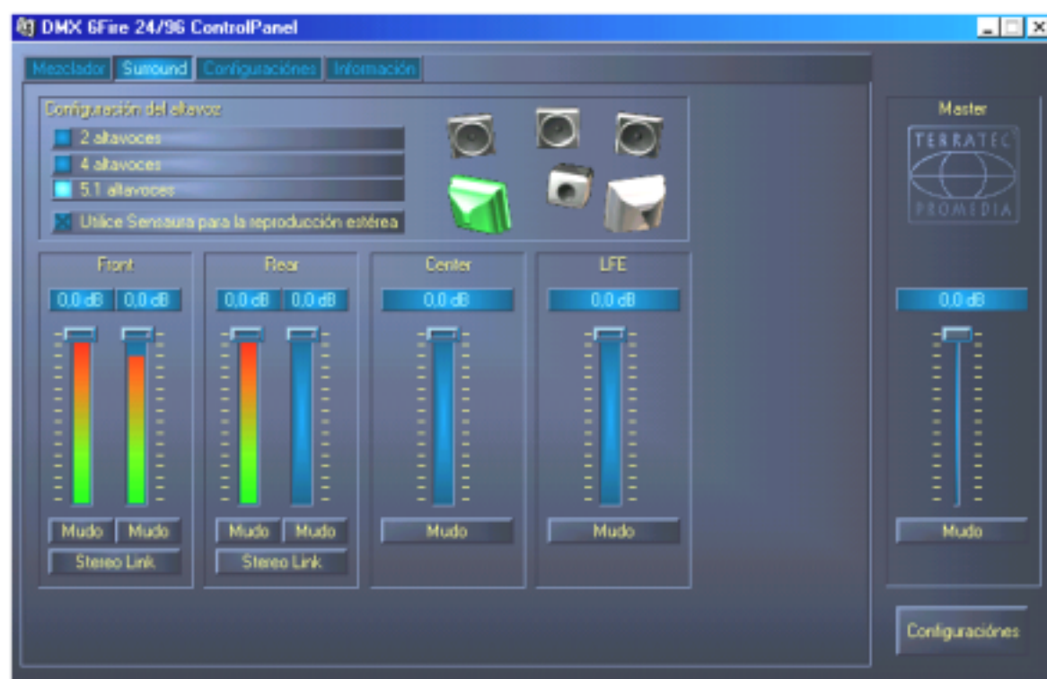
La configuración Surround (envolvente) del DMX 6fire: aquí podrá regular las relaciones de los canales surround entre sí.
