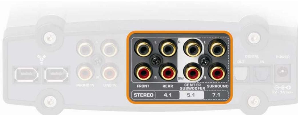
Sul retro del modulo Aureon si trovano 4 coppie di uscite stereo separate. Corrispondentemente alle diciture, potete così realizzare diverse configurazioni di suono surround per poter vedere film o giocare al computer con massimo 8 altoparlanti. Naturalmente, potete pilotare queste uscite anche tramite un'applicazione che supporti l'interfaccia Steinberg ASIO ed in tal modo inoltrare la riproduzione multicanale tramite un mixer o direttamente ad altri apparecchi
